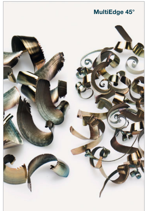
MultiEdge 45°: Kleine Späne durch Spanteilung MultiEdge 45°: Small chips because of chip division
